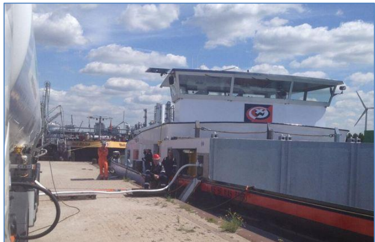
Figuur 26 Eerste LNG bunkering van het binnenvaartschip 'Eiger-Norwand'. Bron: Danser.
