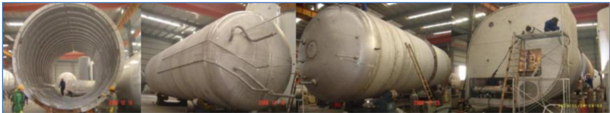
Figuur 12 Type C LNG tank vacuüm geïsoleerd met geïntegreerde cold box. Bron: Wärtsilä
