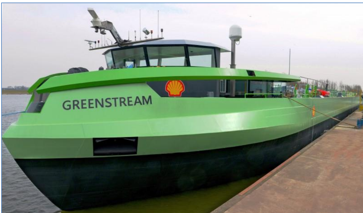
Figuur 4 LNG/elektrisch aangedreven tanker. Bron: Shell.
