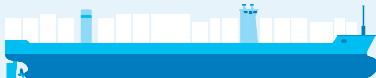
24.000 TEU CONTAINERSCHIP 16M DIEPGANG / AFMETING: 400M LENGTE x 61M BREEDTE
