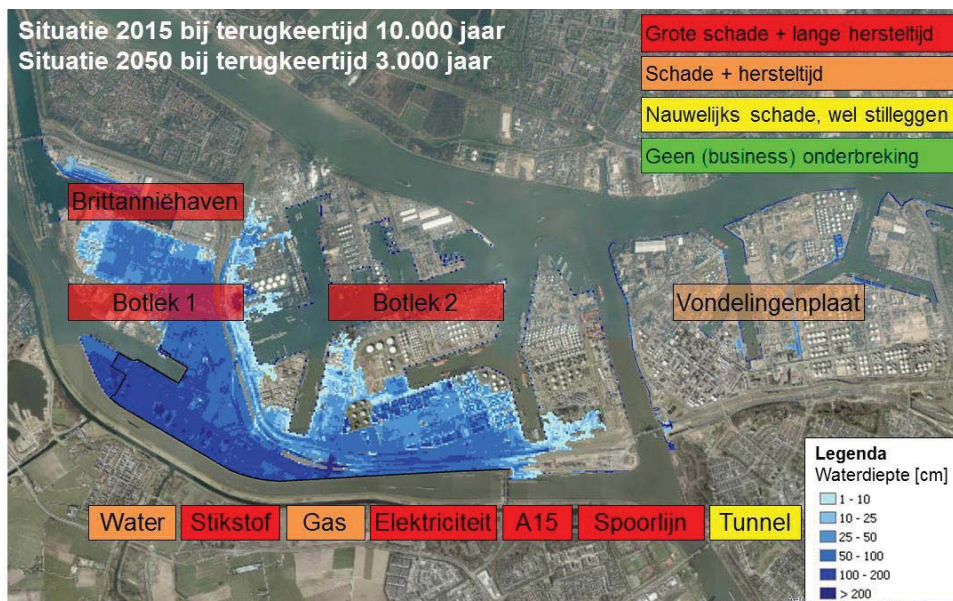
Figuur 14. Indicatie van de gevolgen van een hoogwater in het pilotgebied in gebeurtenis 3 (2050 is gebaseerd op het W+ scenario. Deze indicatie geldt ook voor een situatie in 2100 met een terugkeertijd van 1/1.000 jaar bij W+ voor Botlek 1 en 2. De Vondelingenplaat is in een situatie in 2100 met een terugkeertijd van 1/1.000 jaar ook overstroomd. De totale gevolgen zijn dan heviger dan in de figuur gevisualiseerd.
