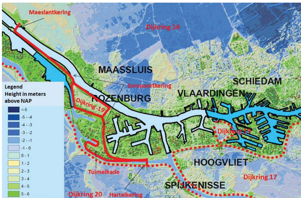
Figuur 8. Waterveiligheidssituatie rondom het pilotgebied Botlek. In rood zijn relevante waterkeringen voor het Pilotgebied Botlek aangegeven zoals de Hartelkering, de Europoortkering, de Tuimelkade, de waterkering rondom Rozenburg en de Maeslantkering. De kleurenschaal geeft een indruk van de hoogte van het gebied t.o.v. NAP.
